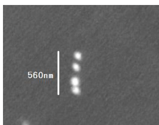
図1 超微粒子乳剤 NIT による低速 Kr イオン (1200km/s, 600 keV) 飛跡のSEM画像
